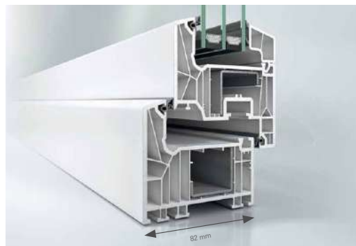
Vysoký stupeň základního zabezpečení: zvětšení stavební hloubky a hluboko uložené kování brání napadání těchto uzamykacích prvků zloději.
